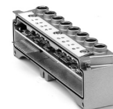
Модуль 8-ми дискретных входов Код. А
